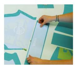
Los papeles de transferencia usados en sublimación son altamente avanzados y desarrollados específicamente para la impresión de sublimación de tinta. Los papeles de transferencia deben tener el nivel adecuado de resistencia a tinta de manera que la tinta no penetre las fibras del papel. Esto asegura que la tinta se quede en el papel luego de
